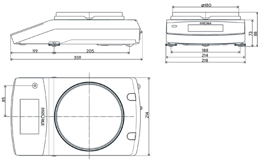
Modèles à la précision de lecture de  $\geq 10$  mg (sauf 3102), en mm
