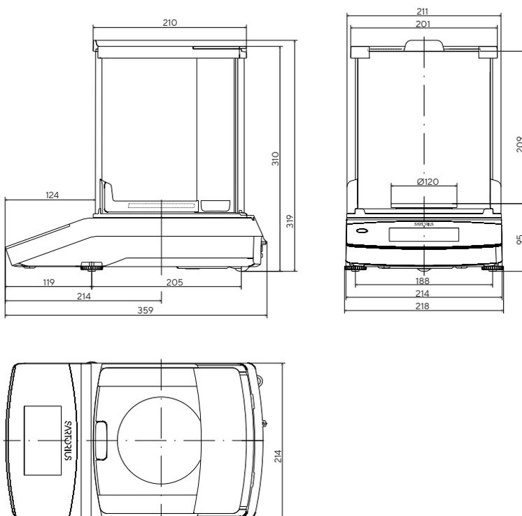
Modèles à la précision de lecture de 10 mg et une étendue de pesée de  $\geq 3,100$  g, en mm
