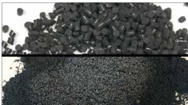
Broyage rapide du caoutchouc fluoro carboné noir (FKM) par fragilisation de l'échantillon à - 100 °C dans des bols de broyage de 125 ml.
