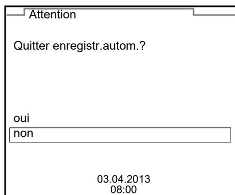
2. Avec **<▲ ><▼ >**, sélectionner *oui* et confirmer avec **<ENTER>**. L'appareil de mesure commute sur l'affichage de la valeur de mesure. L'enregistrement automatique est terminé.
