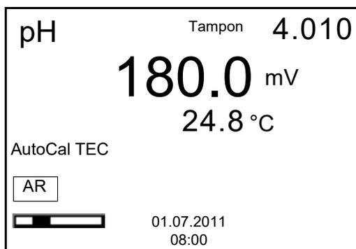
20. Attendre la fin de la mesure avec contrôle de stabilité ou appuyer sur **<ENTER>** pour mettre fin au contrôle de stabilité et reprendre la valeur de calibration.
