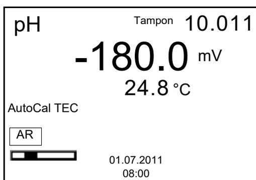
8. Attendre la fin de la mesure avec contrôle de stabilité ou reprendre la valeur de calibration avec **<ENTER>**.
