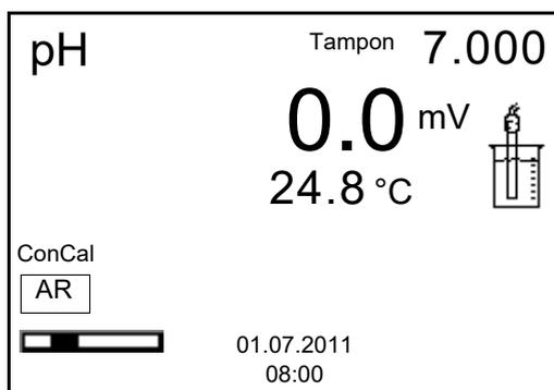
8. Attendre la fin de la mesure avec contrôle de stabilité ou appuyer sur **<ENTER>** pour mettre fin au contrôle de stabilité et reprendre la valeur de calibration.
