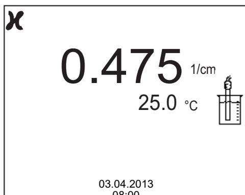
4. Immerger la sonde de conductivité dans la solution d'étalon de contrôle 0,01 mol/l KCl.
