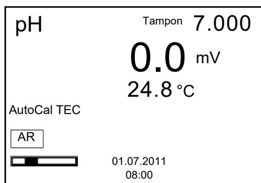
14. Attendre la fin de la mesure avec contrôle de stabilité ou appuyer sur **<ENTER>** pour mettre fin au contrôle de stabilité et reprendre la valeur de calibration.
