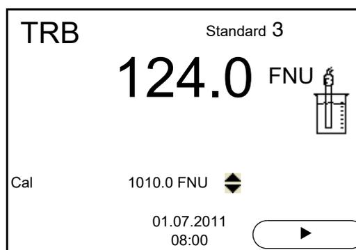
16. Appuyer sur **<M>** pour mettre fin à la calibration comme calibration deux points.
