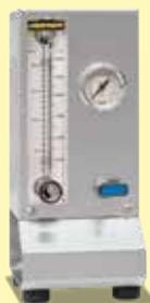
Panneau de gaz pour un gaz inerte ou réactif non combustible (N<sub>2</sub>, Ar, He, CO<sub>2</sub>, air, gaz de fromage)
