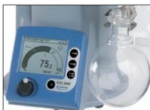
Le CVC 3000 avec clips de fixation peut être directement installé en façade dans l'encoche prévue à cet effet sur un support ; p. ex. sur une pompe **VARIO**®, sur le couvercle d'une gouttière de câbles ou encore sur un tableau électrique.
